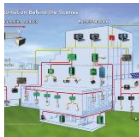
Hệ thống DDC
