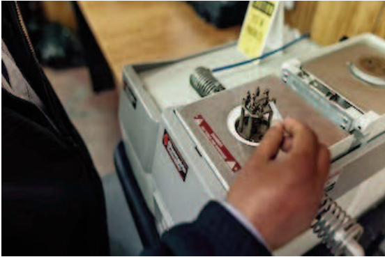
Một thử nghiệm phân tích nhiệt cơ học động được thực hiện để kiểm tra chất lượng quá trình xử lý hoàn toàn của GFRP.
